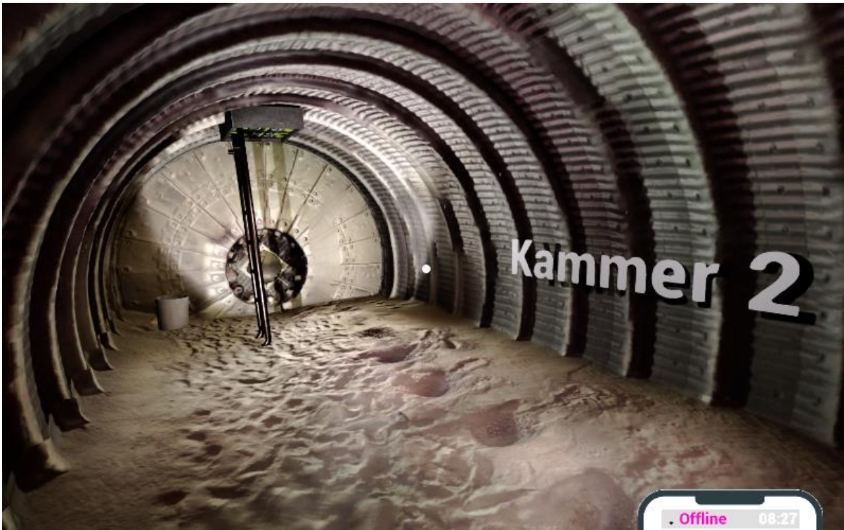
Abbildung 2-3 Innenraum der Kugelmühle
