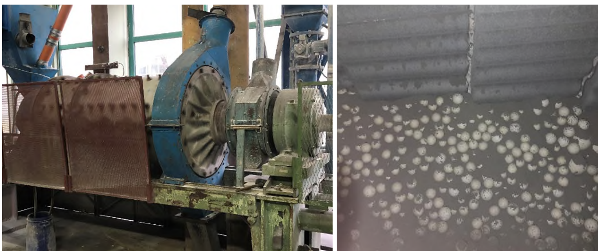
Bild 3-1 Semi-industrielle-Kugelmühle betrieben im Umlauf mit Stabkorbsichter (li.) und Innenraumansicht beim Einsatz von 30 mm-Keramikmahlkörpern und Klinker (re.)
