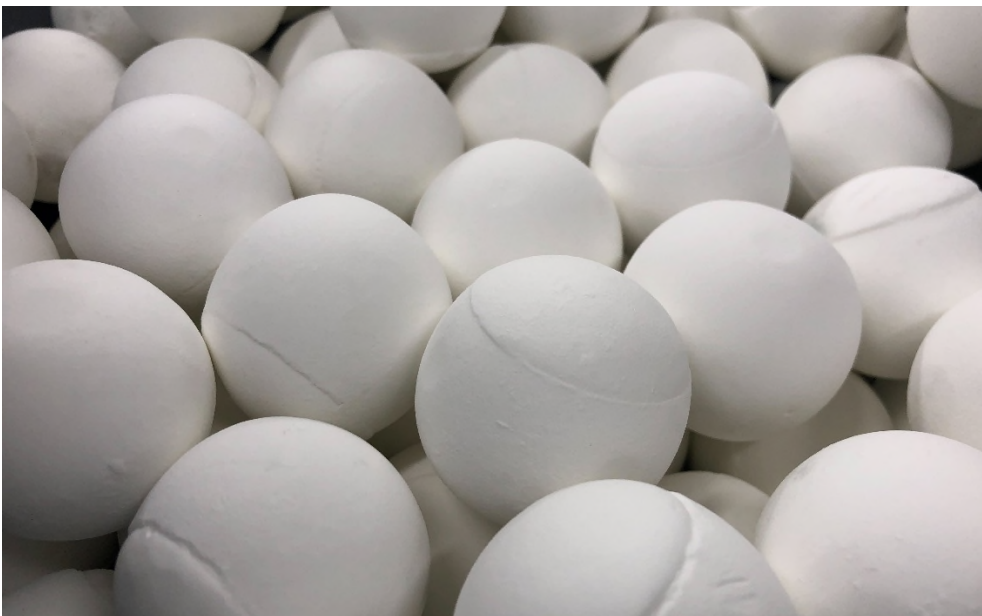
Bild 2-1 30 mm-Keramikmahlkörper im ungenutzten Auslieferungszustand
